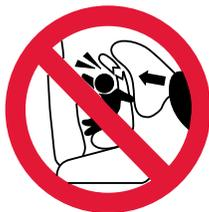
NE PAS placer le siège pour enfant sur le siège avant du véhicule avec un sac gonflable du côté passager. Ceci peut entraîner la MORT ou des BLESSURES GRAVES. Consultez le guide de l'utilisateur du véhicule pour les instructions de l'installation d'un siège pour enfant. Le siège arrière reste l'endroit le plus sécuritaire pour
