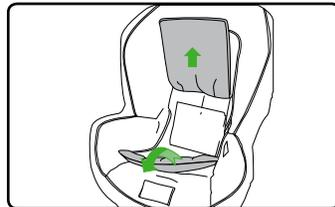
4. Tirez le coussin appui-tête vers le haut, et tirez la housse vers l'avant pour accéder le point d'acheminement de ceinture pour le mode orienté vers l'avant.
